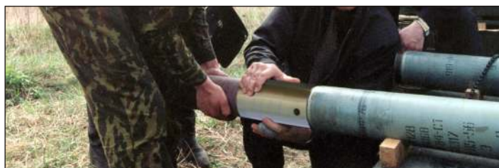
Фото 6. Стыковка ИВЦ-М1(М2) с ракетной частью реактивного снаряда 9М28Д (9М22У)
