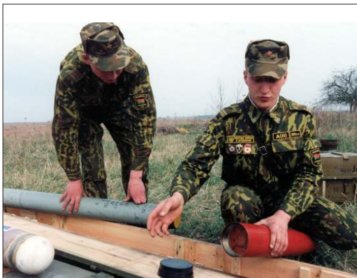
Фото 5. Извлечение ИВЦ-М1(М2) и реактивного снаряда 9М28Д из штатной упаковки
